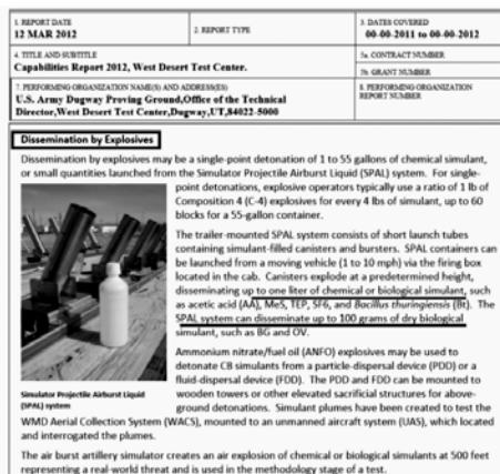
Фото 3. Розпилення за допомогою вибухівки
